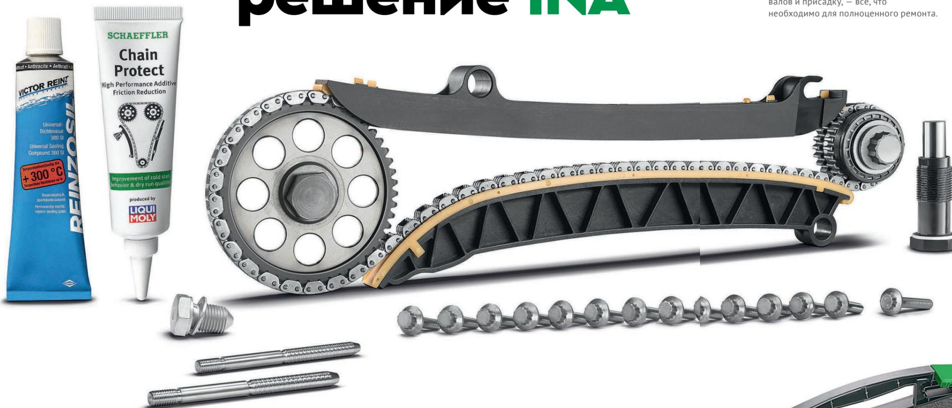
В комплект цепного привода GPM INA для двигателей TSI объемом 1,2 л производства группы компаний VW (артикульный номер 559 0156 30) входят более 25 компонентов, включая звезды коленчатого и распределительного валов и присадку, — все, что необходимо для полноценного ремонта.
