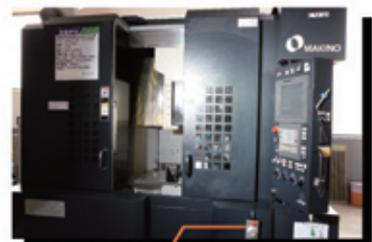
Высокоскоростной фрезерный станок с ЧПУ типа CNC
