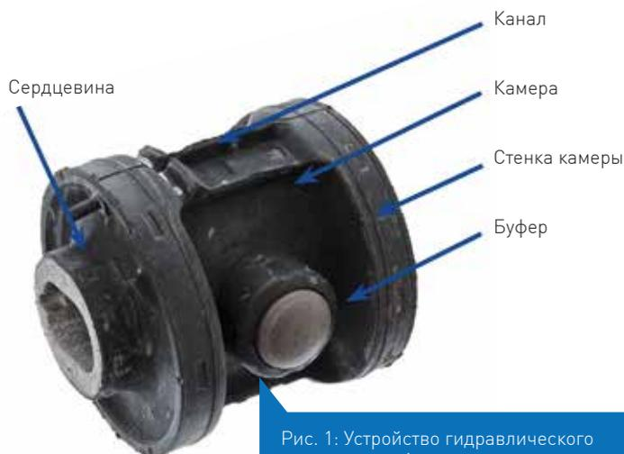
Рис. 1: Устройство гидравлического сайлентблока (без металлической обоймы)
