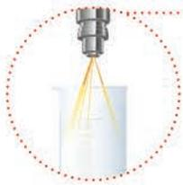
— факел топлива может **сместиться от оптимальной оси** – в итоге топливо не будет попадать непосредственно в область открытия впускного клапана, и наполнение топливной смесью камеры сгорания не будет оптимальным.
