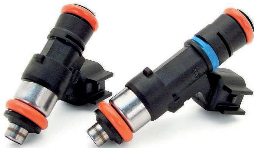
Именно топливная форсунка отвечает за качество приготовления топливоздушной смеси и, в конечном итоге, ее работа существенно влияет на работу двигателя в целом.
