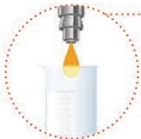
— **запорный клапан может потерять герметичность**, приводя к протечке топлива и ускоряя процесс образования смолистых отложений.
