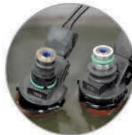
**— очистка форсунок на стенде**
