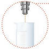
— **снизится качество распыления** топлива, т.е. частицы топлива будут слишком крупными, что ухудшит смешивание топлива с воздухом и, как следствие, ухудшит сгорание смеси в цилиндре, появится рассогласованность в работе цилиндров.
