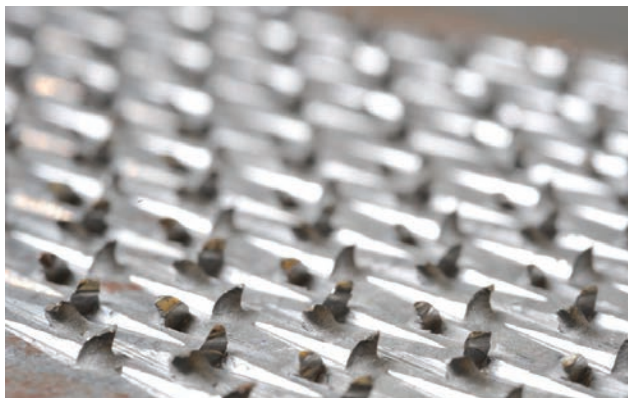
Внешний вид крепления фрикционной накладки, созданной по технологии NRS.
