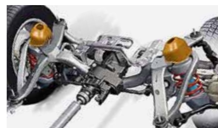
Из строя нередко выходит масляный насос муфты Haldex и блок управления DEM.
