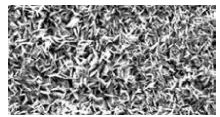
Рис.4 Слой фосфата цинка. Диски — это кристаллы фосфата, которые защищают пружину, и способствуют лучшему нанесению окраски.
