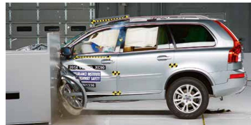
Спустя 10 лет производства XC90 с успехом выдержал фронтальный крэш-тест на скорости 64 км/ч с 25-процентным перекрытием, появившийся в 2012 году.
