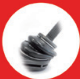
Двухторовый пыльник с двумя хомутами
