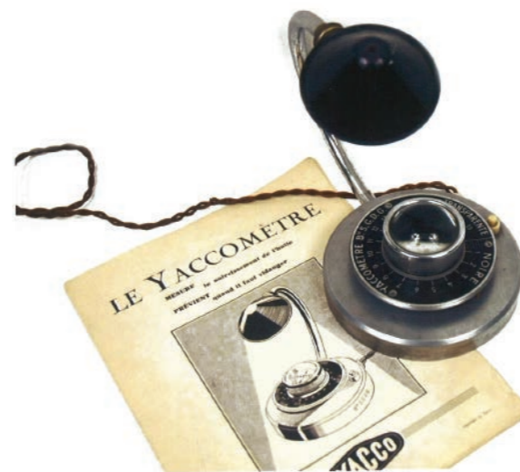
Изобретенный компанией портативный анализатор износа моторного масла, получивший название яккометр (фр. – yaccometre).
